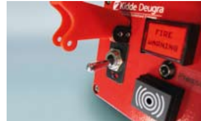
Wahlweise kann die Anlage im rein manuellen Auslösemodus betrieben werden.
