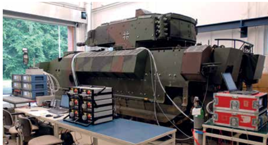
Alle Sensoren sind über besonders brandfeste Kabel mit der zentralen Steuereinheit verbunden, die die gemeldeten Sensordaten überwacht
