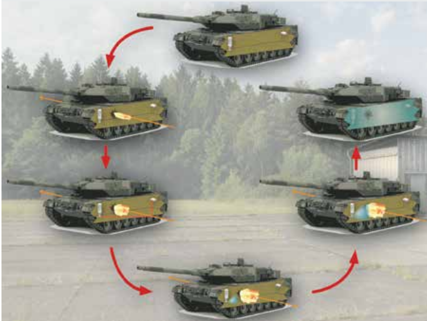
Löschvorgang nach Ausbruch eines Brandes im Kampfpanzer
