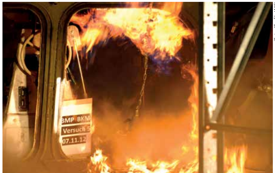
Das Bild vermittelt einen Eindruck von der immensen Brandwirkung eines Molotow-Cocktails in einem Versuchsfahrzeug, das selbst keine brennbaren Materialien enthält
