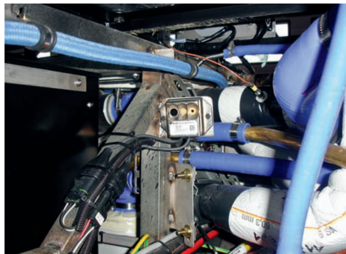
▲ Das neue optische Brandmeldesystem von Kidde-Deugra besteht aus einer Infrarotleuchtdiode (LED) und einer Photodiode zur Branderkennung (Bildmitte) kombiniert mit einer Löschanlage
